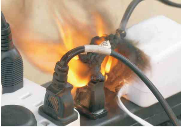
شکل نمبر 8.9 خراب شدہ انسولیشن
